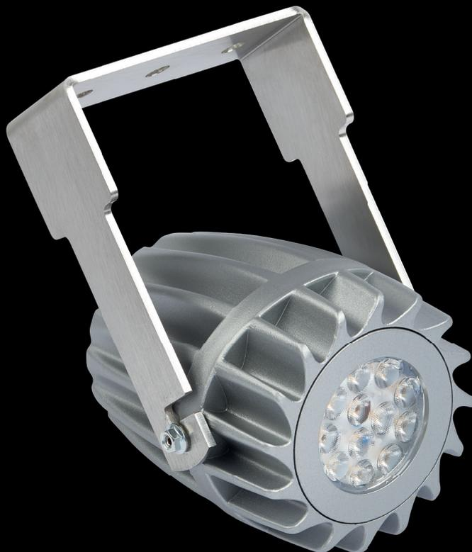
Faretto a 12 led con lenti a fascio stretto (40° e 60°). Corpo in pressofusione d'alluminio, verniciato a polveri e con trattamento superficiale con trasparente antigraffio. Dotato di staffa per fissaggio a parete, con angolo di inclinazione variabile
